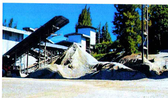
รูปที่ 4 เปลือกดินและเศษหิน นำเข้าโรงเพื่อผลิตเป็นหินคลุก
